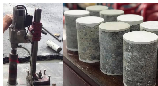
Hình 1. Máy khoan bê tông và mẫu bê tông
